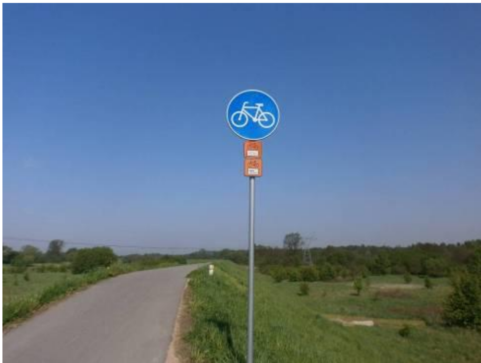
Ilustracja 22: Przykład oznakowania drogowego i turystycznego trasy rowerowej zgodnie z polskimi przepisami
