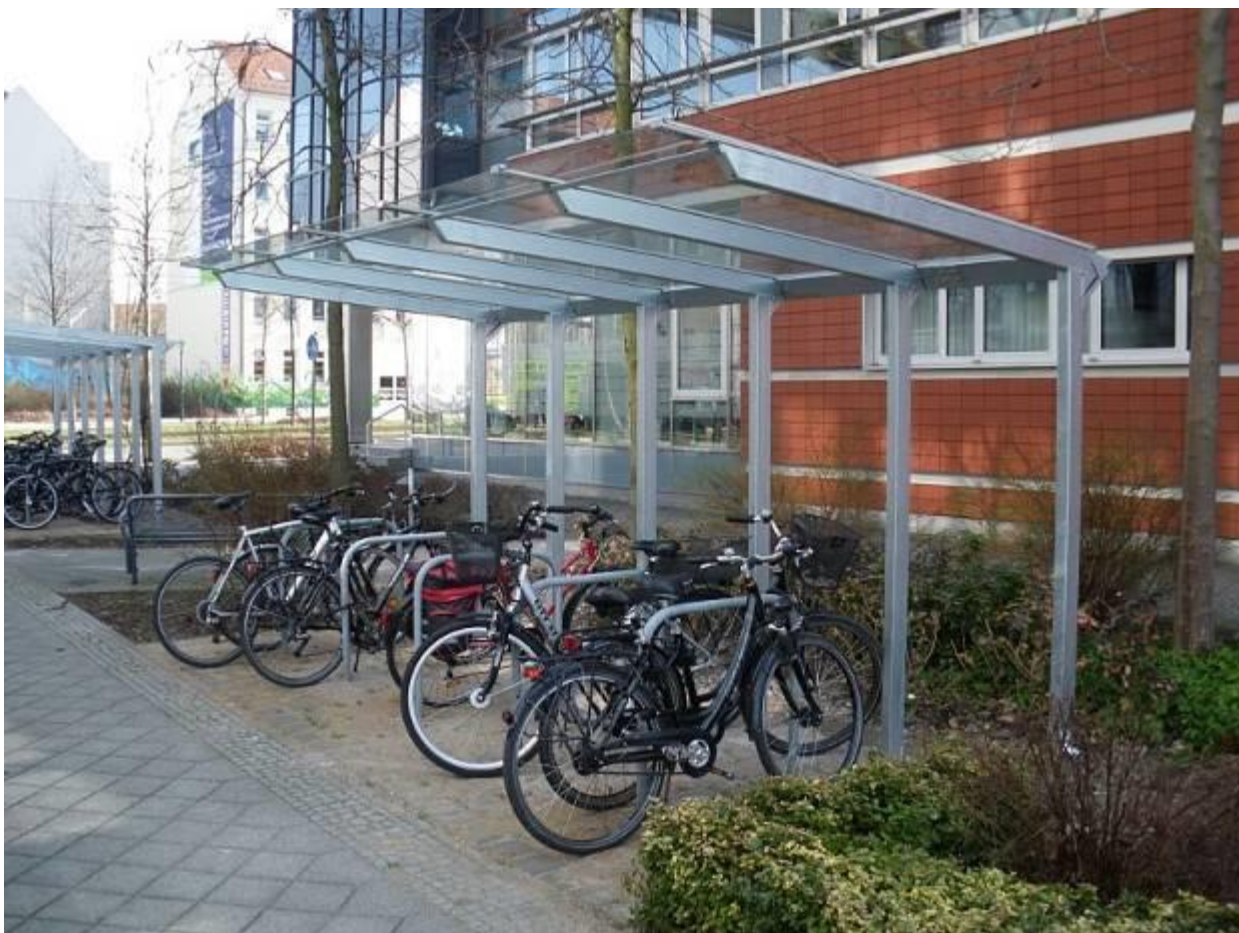
Ilustracja 14: Rekomendowane stojaki rowerowe typu bramka.
