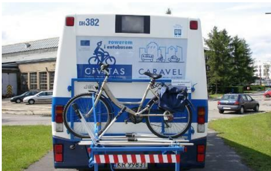
Ilustracja 16: Przykład bagażnika rowerowego zamontowanego z tyłu autobusu
