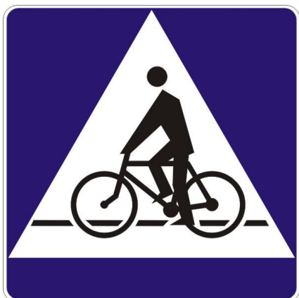
Znak D-6a „przejazd dla rowerzystów” - stosuje się go w celu oznaczenia miejsca przeznaczonego do przejeżdżania rowerzystów w poprzek drogi. Powierzchnię przejazdu stanowi część drogi wyznaczona znakiem poziomym P-11.
