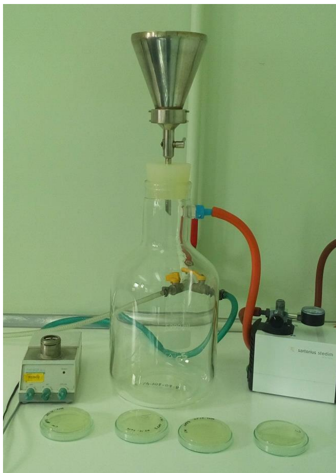
Ilustracja 2. Zestaw do filtracji membranowej - Pracownia mikrobiologii wody laboratorium Wojewódzkiej Stacji Sanitarno-Epidemiologicznej w Kielcach
