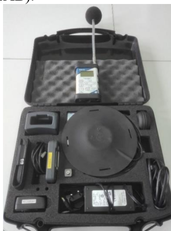
Ilustracja 7. Miernik poziomu dźwięku SVAN 948 oraz zestaw do pomiaru drgań mechanicznych Vib008 – Pracownia fizyczna laboratorium Wojewódzkiej Stacji Sanitarno-Epidemiologicznej w Kielcach
