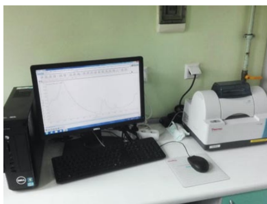
Ilustracja 8. Spektrometr FT-IR Nicolet iS5 z wyposażeniem do oznaczania krystalicznej krzemionki – frakcja respirabilna pyłów (kwarc, krystobalit) – Pracownia pyłów i mikroklimatu laboratorium Wojewódzkiej Stacji Sanitarно-Epidemiologicznej w Kielcach.
