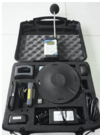
Ilustracja 7. Miernik poziomu dźwięku SVAN 948 oraz zestaw do pomiaru drgań mechanicznych Vib008 – Pracownia fizyczna laboratorium Wojewódzkiej Stacji Sanitarно-Epidemiologicznej w Kielcach.
