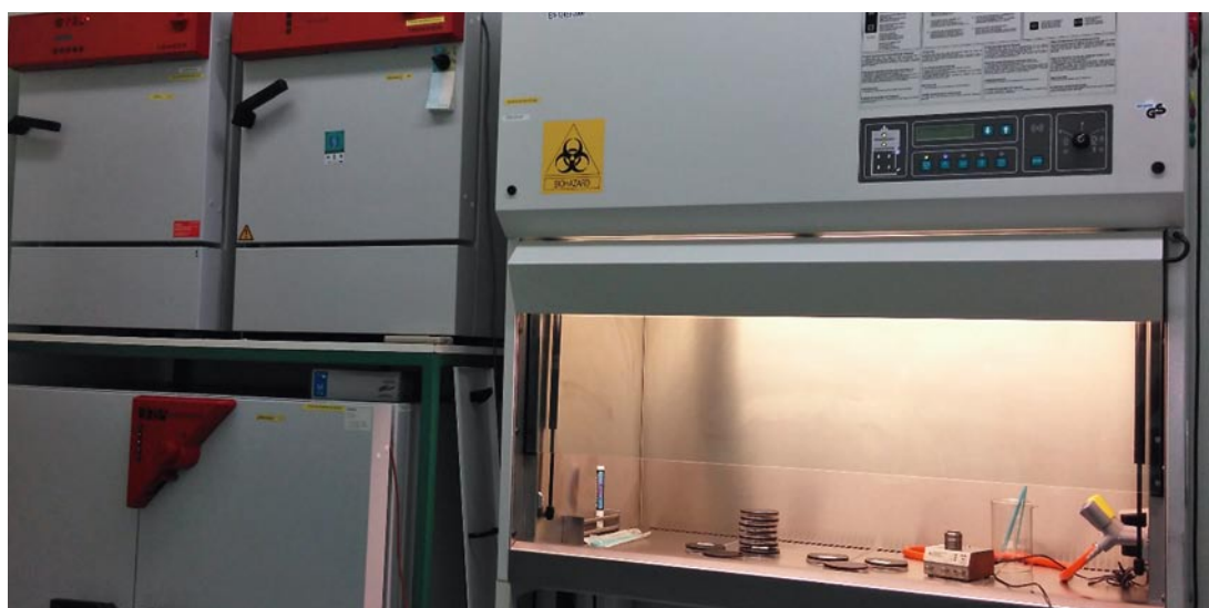
Ilustracja 3. Zestaw ciepłarek, komora laminarna - Pracownia mikrobiologii wody laboratorium Wojewódzkiej Stacji Sanitarno-Epidemiologicznej w Kielcach.
