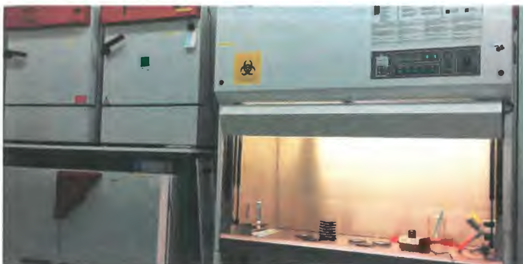
Ilustracja 3. Zestaw ciepłarek, komora laminarna - Pracownia mikrobiologii wody laboratorium Wojewódzkiej Stacji Sanitarно-Epidemiologicznej w Kielcach.
