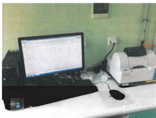
Ilustracja 8. Spektrometr FT-IR Nicolet iSS z wyposażeniem do oznaczania krystalicznej krzemionki – frakcja respirabilna pyłów (kwarc, krystobalit) – Pracownia pyłów i mikroklimatu laboratorium Wojewódzkiej Stacji Sanitarно-Epidemiologicznej w Kielcach.
