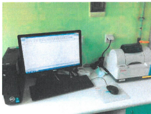
Zdjęcie 4. Spektrometr FT-IR Nicolet iS5 z wyposażeniem do oznaczania krystalicznej krzemionki – frakcja respirabilna pyłów (kwarc, krystobalit) – Pracownia pyłów i mikroklimatu laboratorium Wojewódzkiej Stacji Sanitarno-Epidemiologicznej w Kielcach
