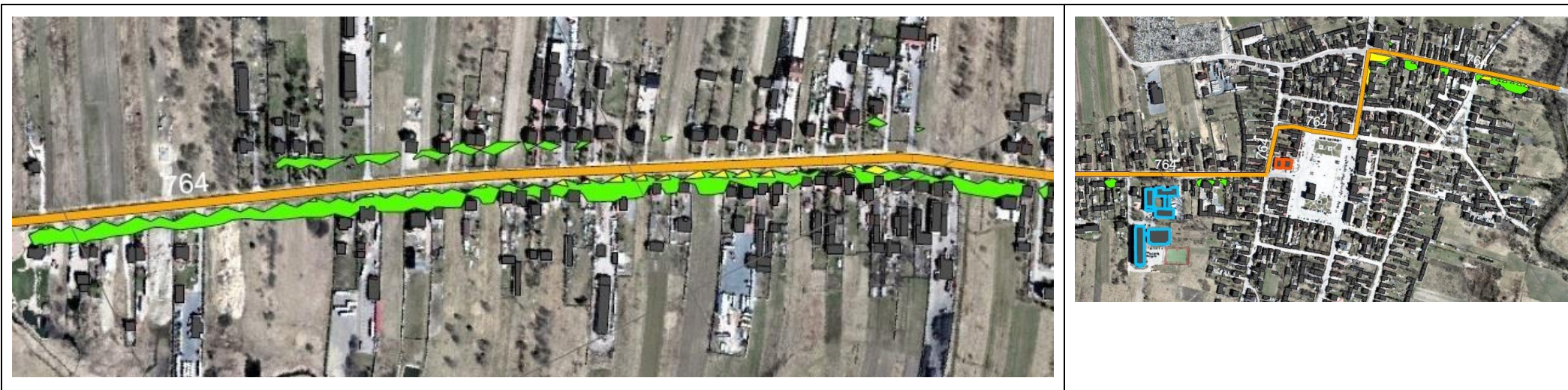
Ryc. 5. Fragment odcinka drogi nr 764 na którym stwierdzono przekroczenia hałasu w zakresie 0-10 dB w porze dnia
