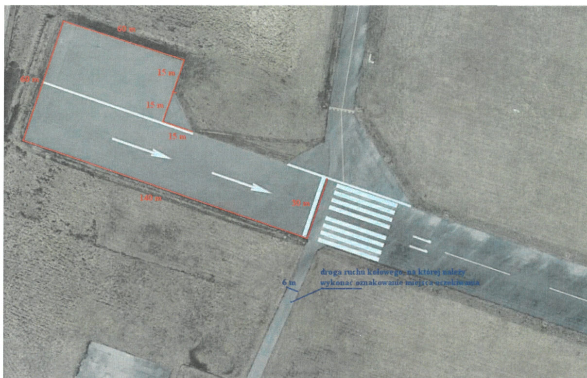
Rys 3. Wymiary płaszczyzny do zawracania na kierunku „29”
