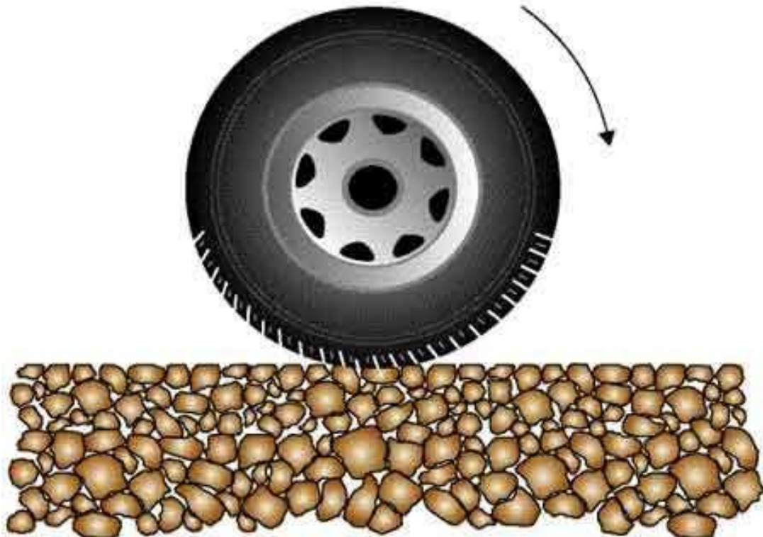
Rysunek 12-3 Asfalt porowaty o dużej zawartości próżni
