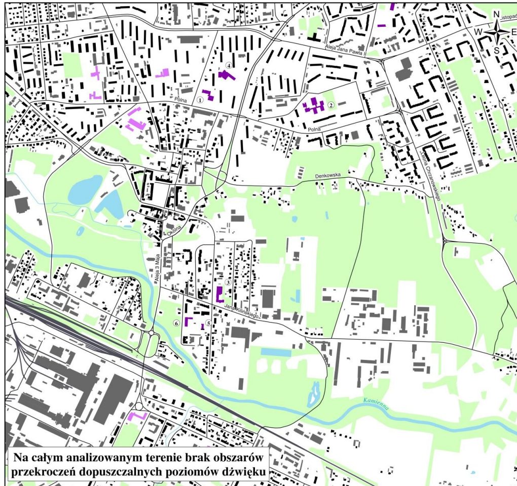
Rysunek 1-18 Przekroczenia dopuszczalnych poziomów hałasu drogowego - drogi wojewódzkie – DW754_3 – wskaźnik L_N
