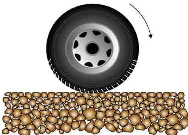
Rysunek 12-3 Asfalt porowaty o dużej zawartości próżni
