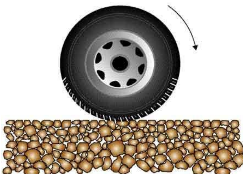
Rysunek 12-3 Asfalt porowaty o dużej zawartości próżni
