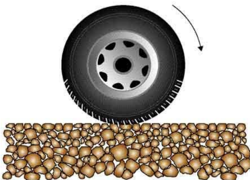
Rysunek 12-3 Asfalt porowaty o dużej zawartości próżni
