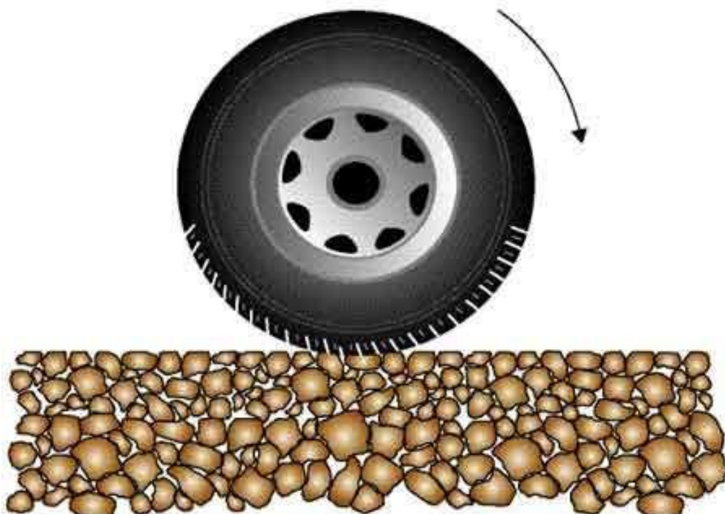
Rysunek 12-3 Asfalt porowaty o dużej zawartości próżni
