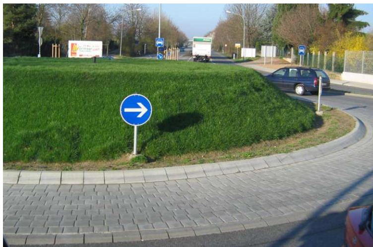
Fot. 7.8. Przykład ograniczenia prędkości i jednoczesnego utrzymania płynności ruchu poprzez zastosowanie ronda (Holandia)
